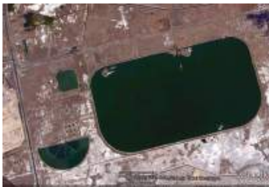
Lagos artificiales creados a través del hundimiento intencional vía bombeo en la zona federal del lago de Texcoco, Google Earth 2009
