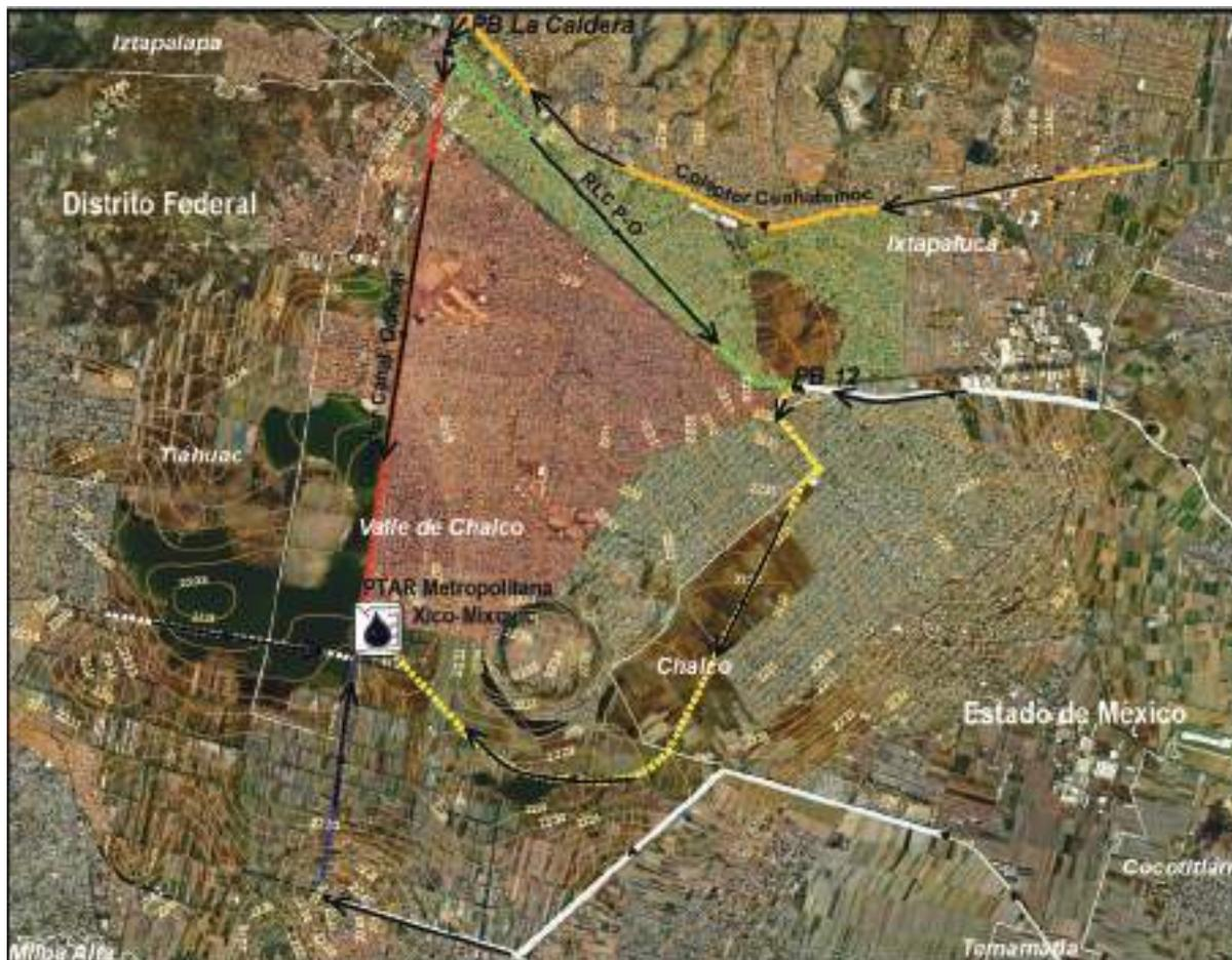
El Plan propone instalar un ducto para canalizar, por gravedad, las aguas residuales actualmente manejadas por el Canal La Compañía, desde la Planta de Bombeo 12 (2236 msnm) hasta la PTAR Metropolitana (2227 msnm), utilizando un trazo que seguiría las isolíneas de hundimiento (para no ser afectado a futuro por hundimientos diferenciales). Las aguas del Colector Cuauhtémoc
