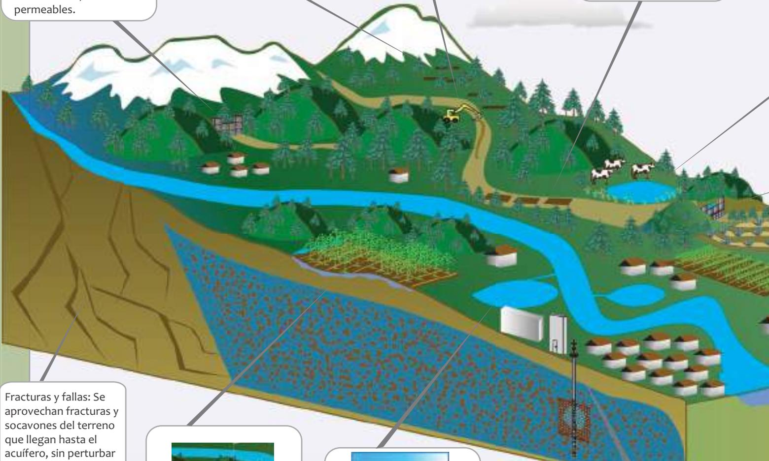
Fracturas y fallas: Se aprovechan fracturas y socavones del terreno que llegan hasta el acuífero, sin perturbar más el terreno.
