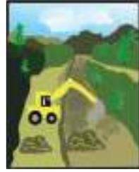
Descostreo de cauces: Eliminación de sedimentos finos para mejorar la infiltración.
