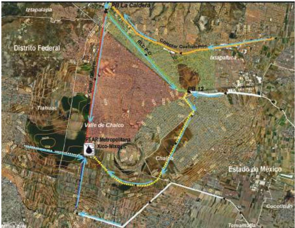
La canalización de los 13.1 Mm<sup>3</sup>/año de aguas pluviales provenientes de la Subcuenca Río La Compañía, principalmente de las Microcuencas San Francisco y Canal, implicará una reorientación de la infraestructura hidráulica existente, para permitir la llegada de este recurso hídrico al Lago por gravedad.
